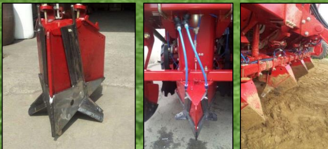
Soc avec 2 ailettes latérales d'injection d'engrais
