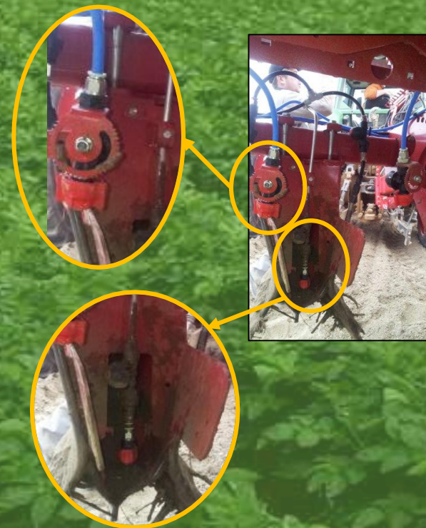
Application du fongicide sous les tubercules et au-dessus après recouvrement.
