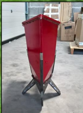
Nouveau soc d'injection d'engrais : 2 ailettes latérales et 1 centrale
