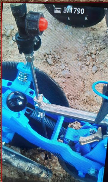
Localisation de l'engrais starter sur la ligne de semis, avec un support découpé laser, canne inox de 8 mm
