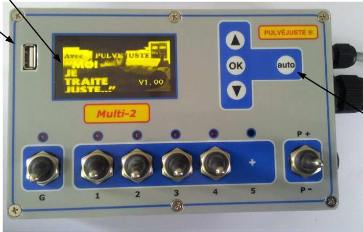
Une touche auto permet de passer en mode contrôleur ou DPAE (PID) la fonction choisie est indiqué sur l'afficheur en haut à droite.
